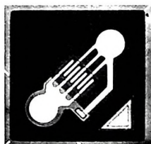
Bild 15. Struktur des Silizium-Planar-Transistors BF 168 von Valvo
